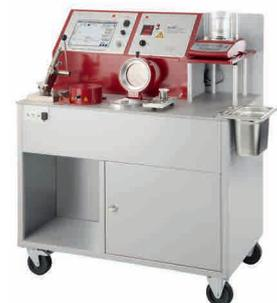
**ALSP highline** inkl. Tiegelvorwärmkammer zur Dichte-Index Ermittlung & Bestimmung der Kornfeinheit und Veredelung zur Bewertung der mechanischen Eigenschaften
